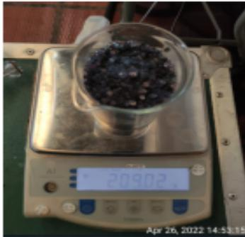
Fotografía 5. Pesaje de Silica, cálculo de humedad
