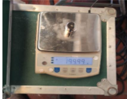
Fotografía 6. Verificación balanza (masa de 200 g).
